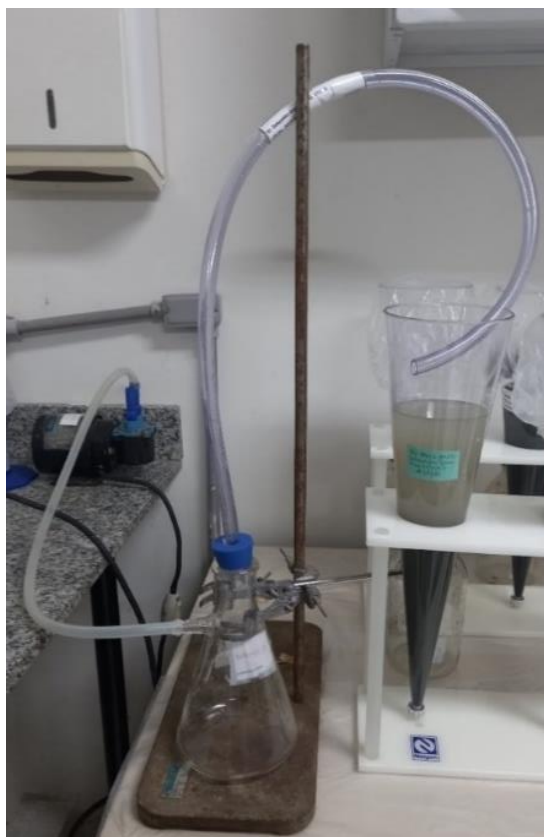
Figura 3: "Setup" para remoção do sobrenadante no cone Imhoff.
