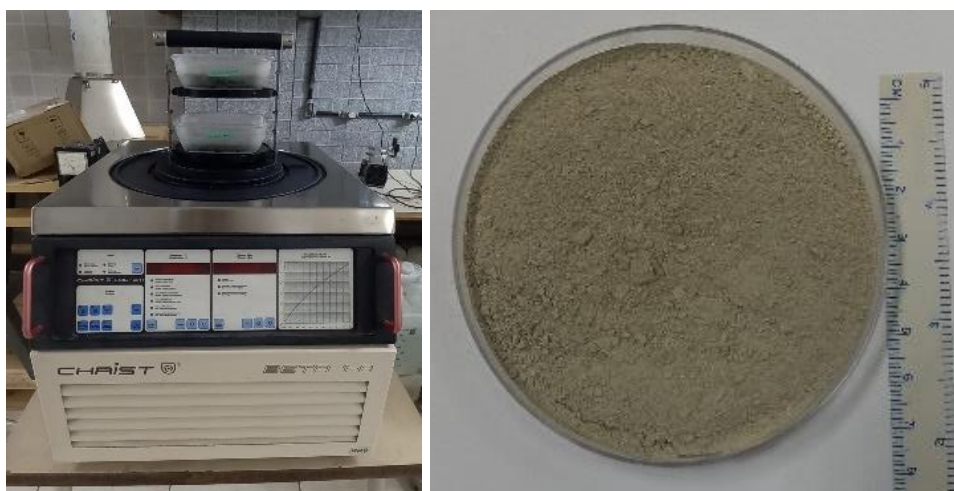
Figura 4: Liofilizador marca Chist e padrão de secagem após "overnight".
