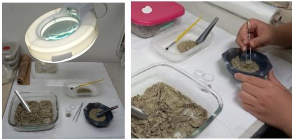
Figura 5: Procedimento para desagregação das amostras e remoção de macrofósseis.
