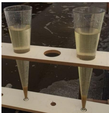
Figura 1: Cone Imhoff utilizado para decantação das amostras de sedimentos.
